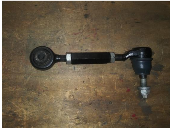
Fig. 2 (factory toe link)
